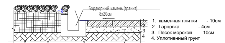
Сопряжение площадки с газоном
